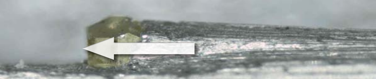
Volně stojící diamant kotouče diaflex viděný ve směru otáčení pod elektronovým mikroskopem
