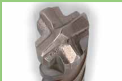
4-břítá vrtací hlava je robustnější a brání „utíkání“ při bočním nárazu na armování.
