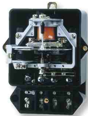
Elektromer EJE927 HF611112z bez veka, štítku a počítacieho strojčeka
