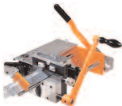
SES-FA 15 manuální stroj, k odpláštění kabelů s tvrdou nebo měkkou izolací max. vnějšího \varnothing 30 mm max. \varnothing vodiče 19mm
