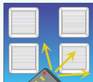
Jednotlivé ventilátory alebo skupiny ventilátorov je možné ovládať pomocou rádiového vysielača (viac sa dozviete pri opise TRM 3).
