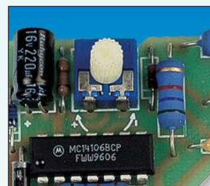
Modely s Timerom (T), jednoduché nastavenie času pomocou otočného ovládača.
