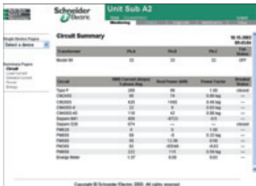
HTML stránka se souhrnnými informacemi ohledně všech přístrojů v rozváděči.
