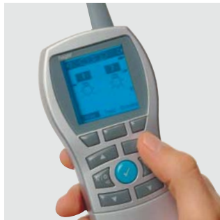
Pomocí programovacího přístroje TX100, lze v libovolném místě budovy jednoduše nastavit komunikaci mezi jednotlivými přístroji, včetně jejich funkcí. Přístroj zároveň umožňuje měření intenzity a kvality radiového signálu.
