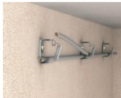
Vložení vedení Vložení vedení do svazkových držáků. Po vložení kabelů se uzavřou svazkové držáky zaháknutím výklopné části do příslušného otvoru.
