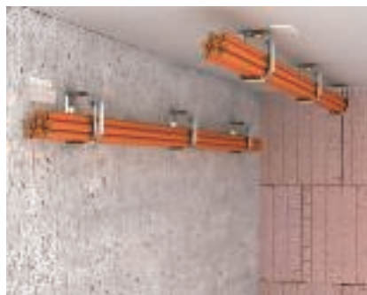
Zachování funkčnosti se svazkovým držákem Kovové svazkové držáky jsou otestovány a schváleny pro specifické ukládání vedení podle DIN 4102-12, STN 920205 i ZP 27/2008 PAV-US. Vzdálenosti upevnění a schválené typy kabelů naleznete v Katalogu požární ochrany OBO BSS.
