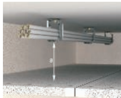
Oblast použití: protipožární strop Při používání nad protipožárními stropy je nutné zachovat příslušnou minimální vzdálenost. Vzdálenost „a“ k protipožárnímu stropu pro svazkové držáky: Při vzdálenosti upevnění 60 cm: a = min. 100 mm při prověšení kabelů max. 30 mm Při vzdálenosti upevnění 80 cm: a = min. 250 mm při prověšení kabelů max. 50 mm
