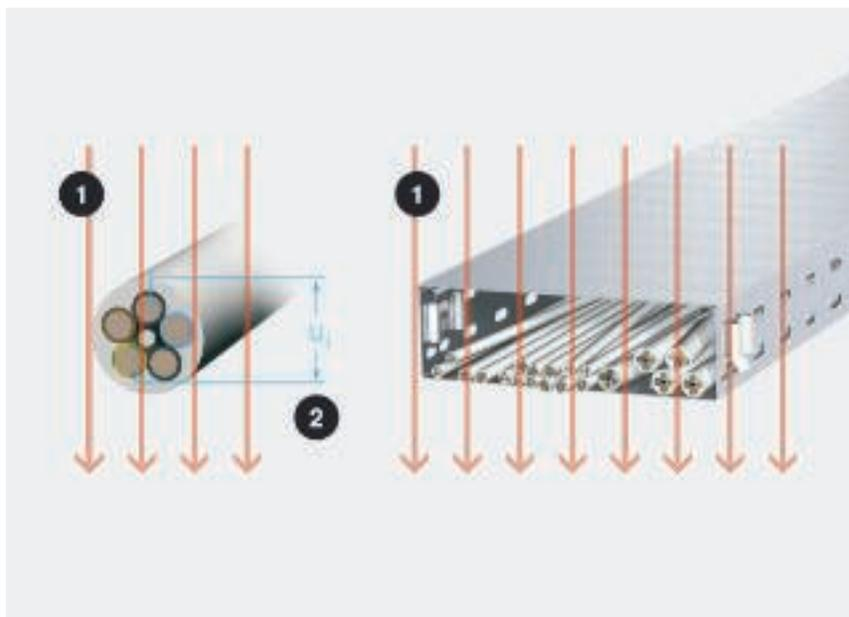
Magnetické impulzní pole (H) s intenzitou 3 kA/m při definovaném pokusném modelu: vlevo bez kabelového nosného systému, vpravo s kabelovým nosným systémem. 1 = pole H, 2 =  $U_{1, L_{20}PE}$
