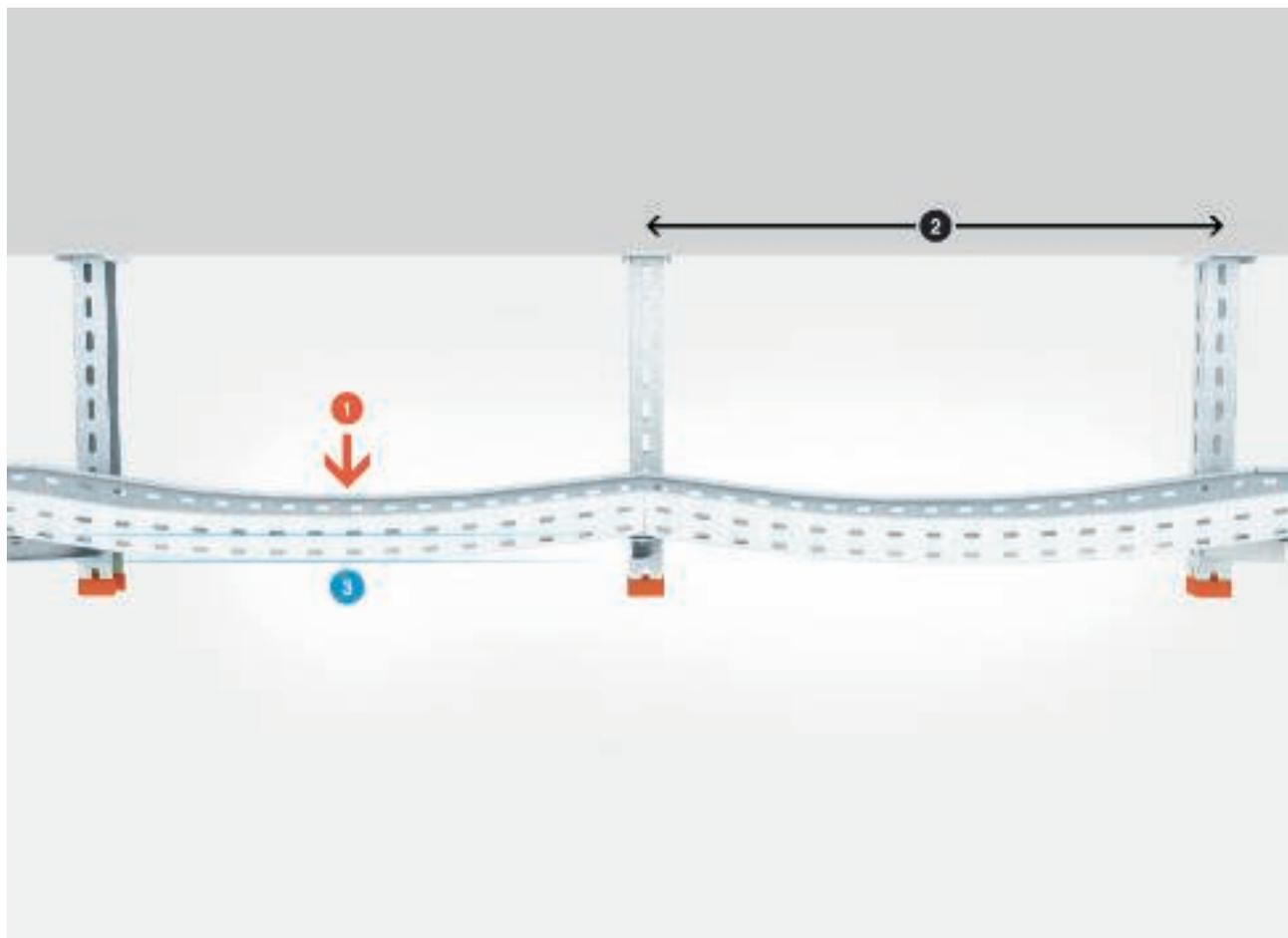
Vysvětlení piktogramů: 1 = zatížení v kN bez zatížení člověkem, 2 = rozestup podpěr v m, 3 = průhyb bočnice v mm
