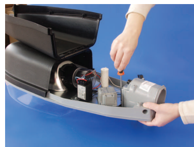
Předradníkovou desku lze vyjmout po demontáži tří samořezných šroubů.
