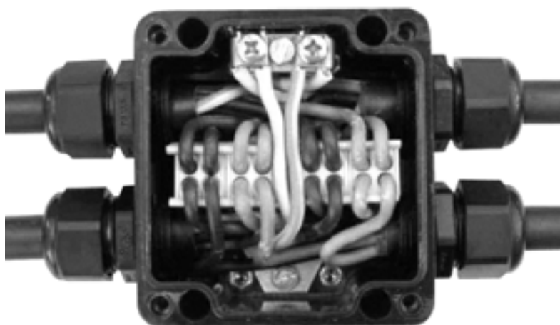
Příklad zapojení 4 kabelů CYKY 5C × 2,5 mm 2
