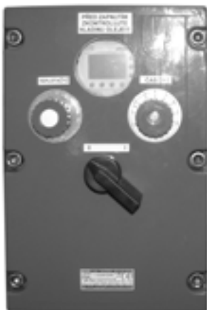
RP 25 Ex - řídicí skříň typu X103HM se zabudovaným mikrokontrolérem
