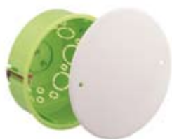
HW - Dvojitá přístrojová krabice ø 2 x 68 mm, hloubka: 50 mm
