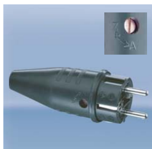
Vidlice celogumová s rychlouzávěrem pro rychlou montáž dle CEE 7/VII krytí IP 44 \diamond pro vodiče do 3 x 2,5 mm 2
