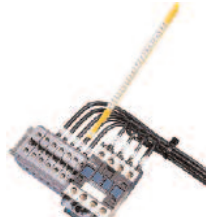
PLIOSNAP plus jsou vhodné pro popis adových svorek. Označovací kroužky téměř sn obepnou vodiče. Pliosnap+ umožňuje popis vodičů i v úzkých prostorech.
