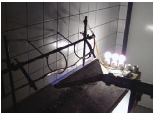
podle ČSN IEC 60331 - zkouška izolační integrity
